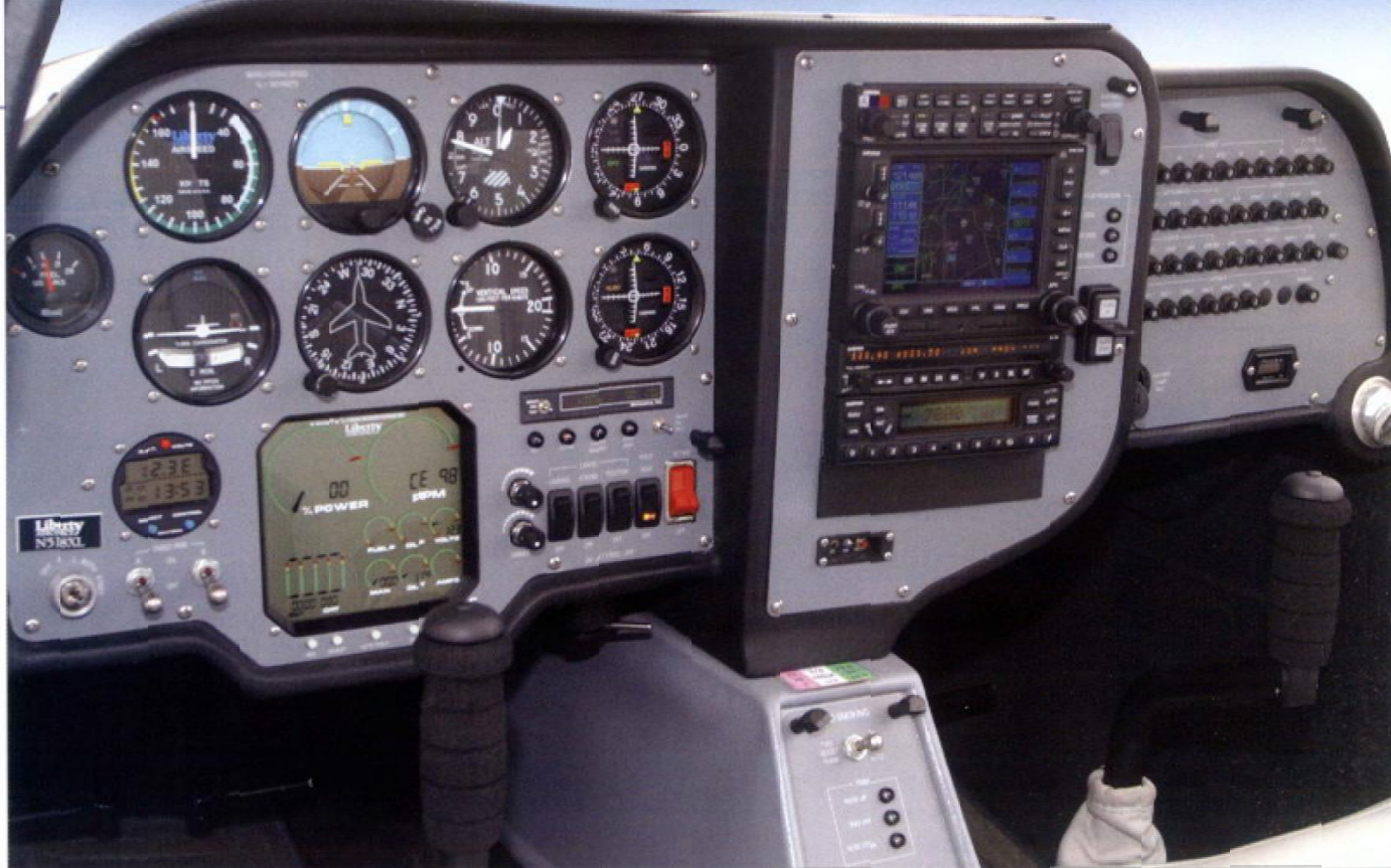
La planche de bord semble un peu décalée par rapport aux nouveaux standards, et, pourtant, elle est moderne avec son écran Vision Microsystems, et ergonomique. Sa partie centrale, avec Garmin 530, est bien orientée vers le pilote. Seuls les 3 voyants de position des volets sont illisibles : à revoir.
